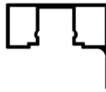
profil no: 4103 weight/ağırlık: 0,673kg/m
