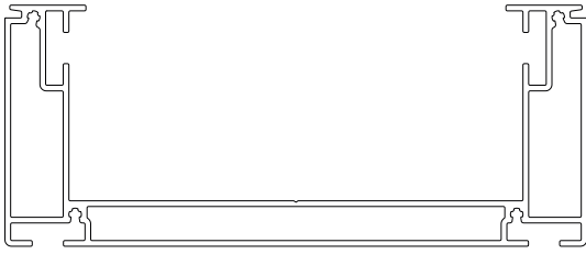
Profil No: 2337 Weight / Ağırlık: 4,555 Kg/m
